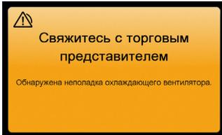
Общая неисправность системы (Этот экран указывает на неисправность охлаждающих вентиляторов генератора)
