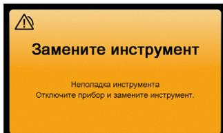
Указывает на неисправность в схеме опознавания инструмента. Для подключения к разъёму генератора и идентификации генератором в отдельные дополнительные инструменты установлены специальные электрические схемы.
