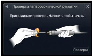
Проверка лапаросонической рукоятки. Присоедините провероч. наконеч., чтобы начать.
