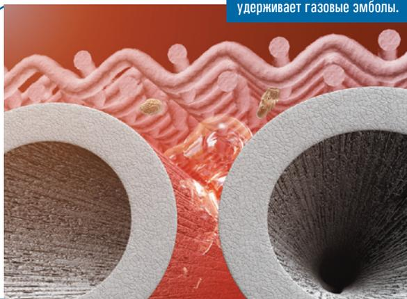
Под действием градиента давления газовые эмболы поступают в просвет микропористого полого волокна и удаляются через газовый порт выхода.
