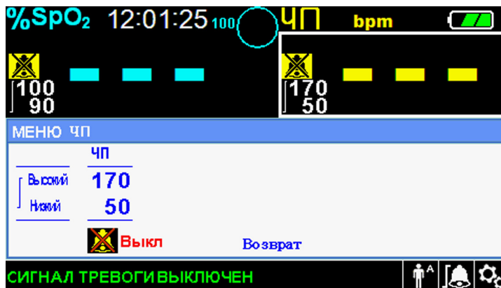
рис.4-4. Меню БЫСТРОГО ДОСТУПА ЧП с отключенным звуковым сигналом тревоги
