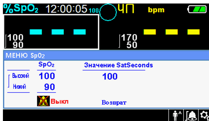
рис.4-3. Меню БЫСТРОГО ДОСТУПА SpO 2 с выбранным звуковым сигналом тревоги
