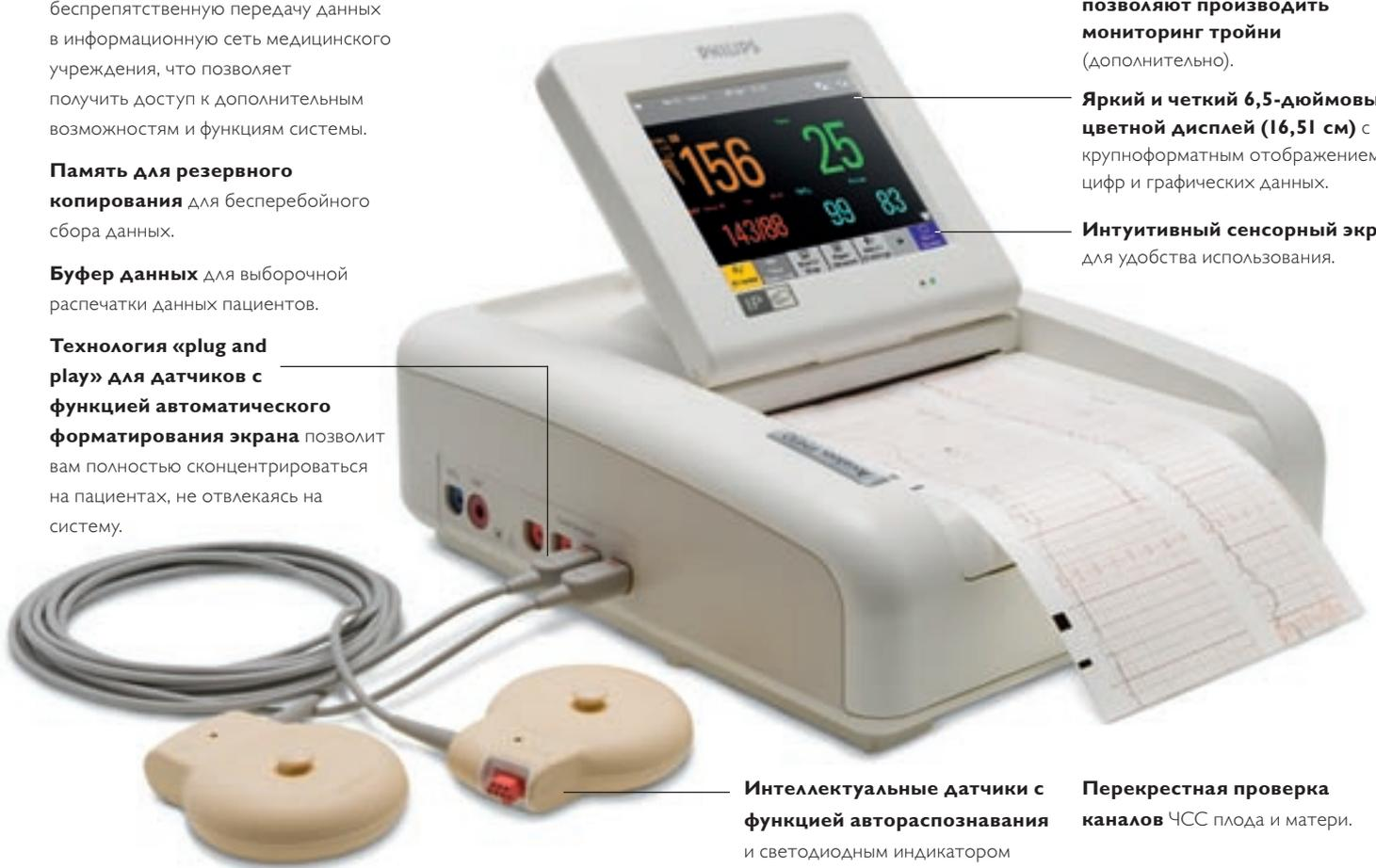
**Интеллектуальные датчики с функцией автораспознавания** и светодиодным индикатором обнаружения датчика значительно упрощают работу.
