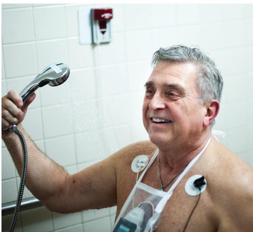
**Монитор IntelliVue MX40 выдерживает случайное падение с высоты 1 метра. Также его можно ненадолго погружать в воду, в том числе при приеме душа пациентом.**
