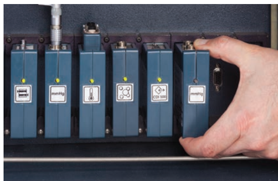
Система 1 компании Терумо позволяет интегрировать до 18 модулей. Эти компактные модули подключаются к разъемам базы системы.
