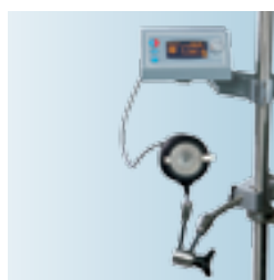
Компактные размеры центробежных насосов позволяют легко устанавливать их на стойке АИКа
